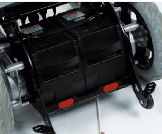
Mecanismo de bloqueo patentado y kit de baterías
